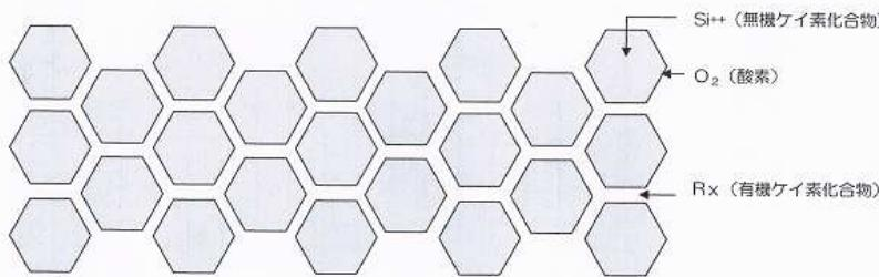
・荷電化処理により、強力にイオン化された無機ケイ素化合物及び有機ケイ素化合物が六角網目状に配列し同時に素材の面に密着します。・水及び空気中の酸素と結合し、透明で且つ光沢のある被膜に変化します。・水分が徐々に蒸発して、韌性のある硬質ガラスに変化していきます。
